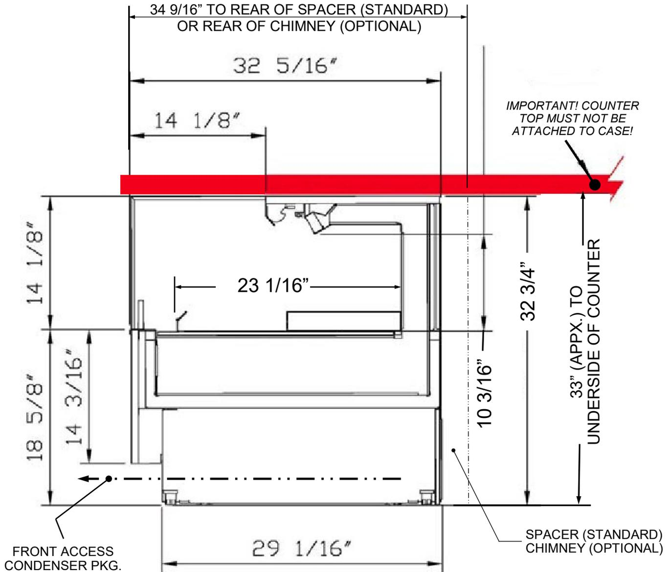
**SIDE SECTION LAYOUT - MODEL COXX24R-UC ONLY / UNDERSIDE OF TOP COUNTER**
